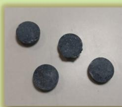
Figura 5. Pastillas de  $ZnO$  AIJU + 2% resina (TT 600°C).
