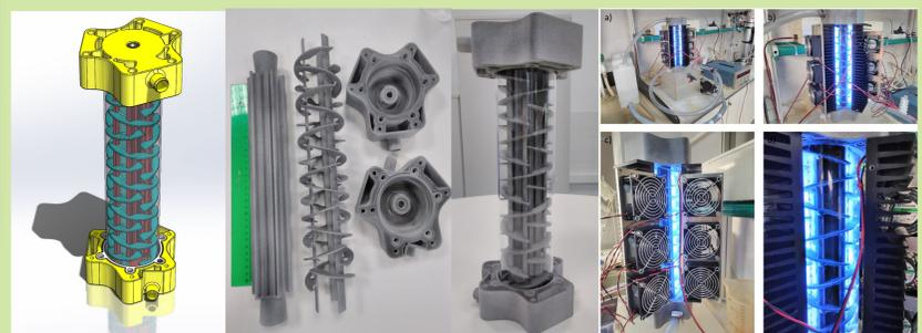
Figura 9. Diseño 3D, montaje y puesta en marcha del reactor piloto.
