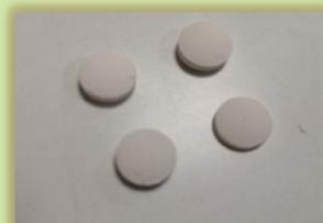
Figura 6. Pastillas de Mix comercial 2 (60%  $ZnO$ -40%  $TiO_2$  Comercial) 600°C.
